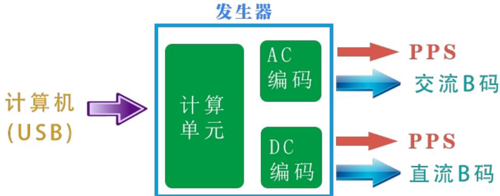
通过配置软件，可以输出任意时间，特别是对临界时间的测试，比如 2099 年 12 月 31 日 23 时 59 分 59 秒。同时它还可以设置闰秒、主站/副站特标信号等。发生器也可以通过配置软件，任意设定交流 B 码的输出幅值  $V_{p-p}$ ，调制比等，同时根据选配可以同时支持直流 B 码。
