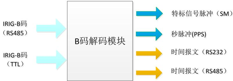
模块具有处理速度快，输出精度高的特点，秒脉冲误差约 60ns，能满足设备对时间的高精度要求。
