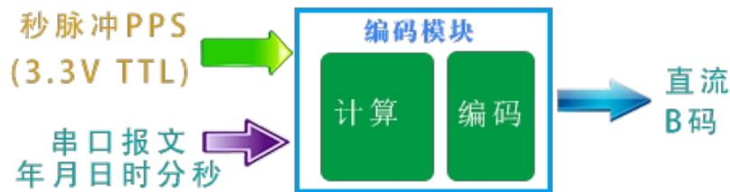
编码模块具有高速逻辑处理能力，具有低延迟，高速度、使用简单等特点。
