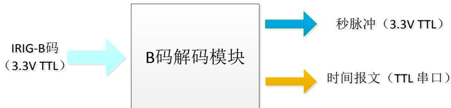
模块具有处理速度快，输出精度高的特点，秒脉冲误差在 10ns 左右，能满足设备对时间的高精度要求。
