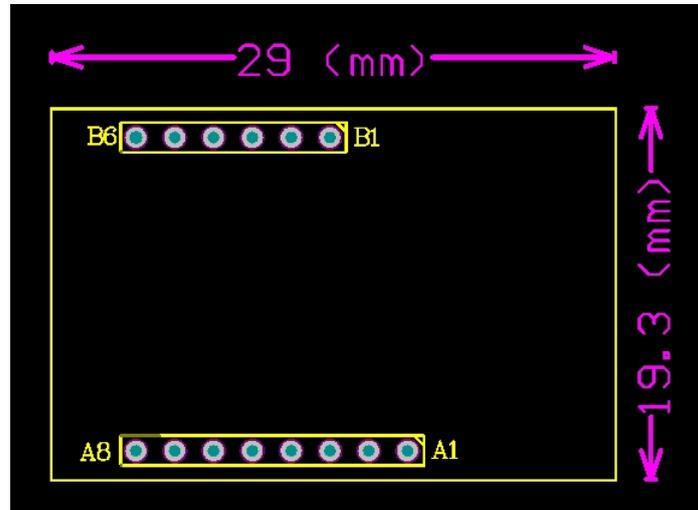
使用 2mm 单排针连接，焊接到底板上
