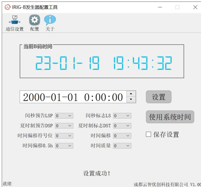
1. “当前 B 码时间”：显示 B 码发生器此时的输出时间；
